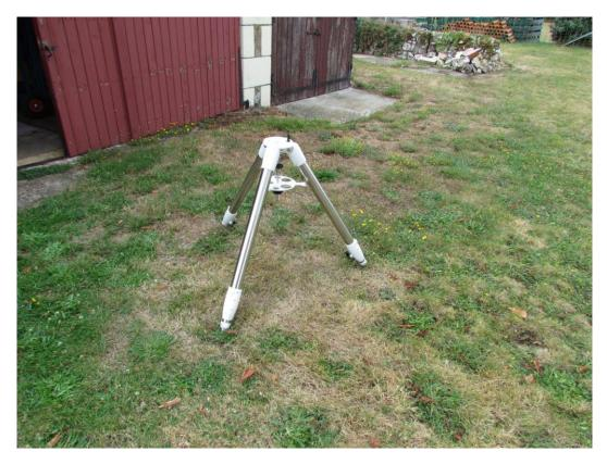
Le doigt a été démonté et remonté à l'opposé de sa position initiale. Maintenant en orientant le trépied vers le nord, on a le pied coté du doigt vers l'avant du télescope et les deux pieds arrières vers le sud.
